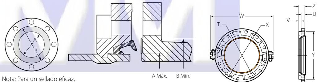
Nota: Para un sellado eficaz, el área sombreada de la cara acoplada no debe tener perforaciones, ondulaciones ni deformidades de ningún tipo.
