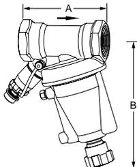
Los controladores TA de presión diferencial vienen por defecto con un kit de drenaje, un puerto de medición, un niple de transición y una herramienta de ajuste. La conexión de extremo en tamaños 1/2"/15 mm a 2"/50 mm son todas roscas IPS hembra solamente. Las soldadas no están disponibles.
