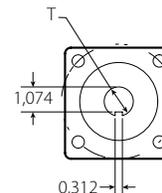
BRIDA DE MONTAJE EXPANDIDA TÍPICO DE TAMAÑOS DE 10"/250 mm (LA VÁLVULA APARECE CERRADA)
