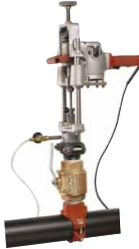
La herramienta Vic-Tap es perfecta para aplicaciones en que los sistemas no se pueden sacar de servicio para agregar conexiones de derivación. Capaz de perforar derivaciones en sistemas de tuberías de acero a presiones de 500 psi/3450 kPa, la herramienta Vic-Tap reduce automáticamente la parte desprendible de la tubería y evita posibles daños a equipos en la tubería, vea la pág. 20-11.
