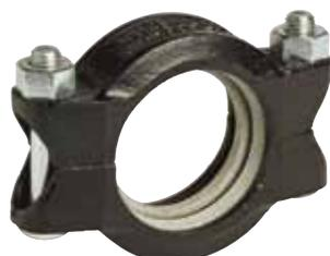
Los productos EndSeal están específicamente diseñados para cumplir con los exigentes requerimientos de los sistemas de tuberías de campos petrolíferos. El perfil especial de ranura y el diseño de la empaquetadura de los productos "ES" contribuyen a una mayor capacidad nominal de presión y una mayor vida útil.
