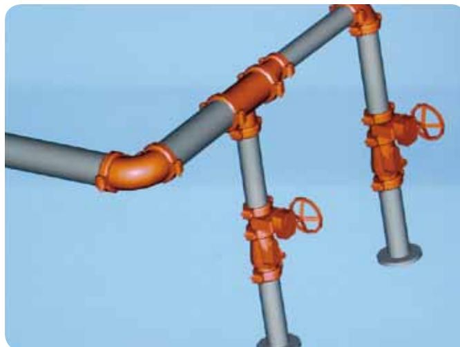
*Vic-Blocks – diseñado específicamente para usuarios de AutoCAD, Vic-Blocks 3D es una biblioteca de bloques tridimensionales exactos desarrollada para ayudar al diseño de sistemas de tuberías Victaulic. Incluye símbolos de bloque que representan la línea principal de productos, dibujada a escala real.*
